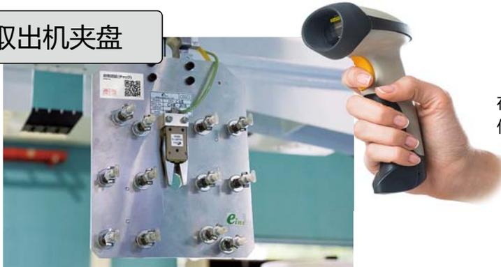
在调用成形条件后，再读取取出机夹盘的QR码。当成形条件和取出机夹盘不一致时，可禁止连续运转。
