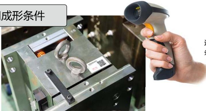
通过读取已转换为QR码的模具识别编号，可自动调用成形条件。可彻底省去条件设定的工夫。
